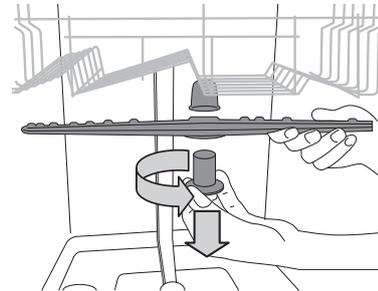
Zur Abnahme des oberen Sprüharms drehen Sie den Kunststoffring gegen den Uhrzeigersinn ab. Der obere Sprüharm ist mit jener Seite nach oben wieder einzusetzen, die die meisten Löcher aufweist.
