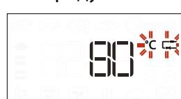
Натисніть кнопку або , щоб підтвердити та запустити цикл готування. Під час циклу приготування дисплей відображає цільову температуру щупа для м'яса. Коли м'ясо досягає заданої цільової температури, цикл приготування зупиняється, а дисплей показує слово "End".
