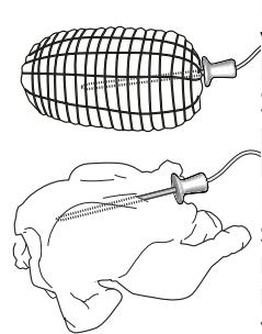
Precízne umiestnenie sondy je veľmi dôležité na dosiahnutie bezchybných výsledkov pečenia. Sondu zapichnite do časti, kde sa nachádza najviac mäsa. Vyhýbajte sa kostiam a častiam s tukom. Pri hydine sa sonda vkladá zboču do stredu prás, tak aby sa špička sondy nedostala do dutej časti. Ak má mäso rôznu hrúbku, pred vybratím z rúry skontrolujte, či sa upieklo rovnomerne. Koniec sondy pripojte do otvoru na pravej stene priestoru rúry.
