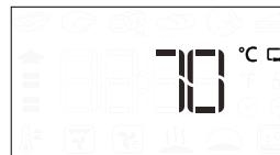
Stlačením spustite nastavenia. Otáčaním gombíka nastavte cielovú teplotu mäsovej sondy. Stlačením potvrdte. Otáčaním gombíka nastavte teplotu priestoru rúry.
