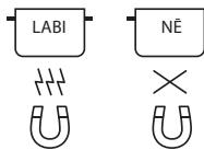
Izmantojet tikai feromagnētiska materiāla katlus un pannas, kas ir piemērotas izmantošanai ar indukcijas plīts virsmām:
