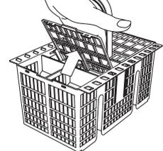
Er ist oben mit Gittern versehen, um das Besteck besser einzuordnen. Er darf nur im vorderen Teil des unteren Korbes eingesetzt werden.
