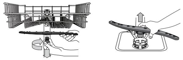
Zur Abnahme des oberen Sprüharms drehen Sie den Kunststoffstift im Uhrzeigersinn ab.
