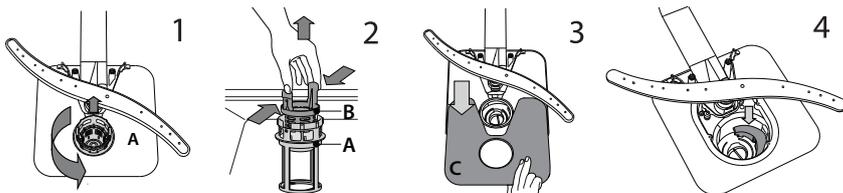
Falls Sie Fremdkörper (wie Glasscherben, Porzellan, Knochen, Fruchtsamen usw.) finden, **entfernen Sie diese bitte sorgfältig**. Das Spülpumpenschutzteil (schwarzes Teil) **NICHT ABGENOMMEN WERDEN** (Abb 4).
