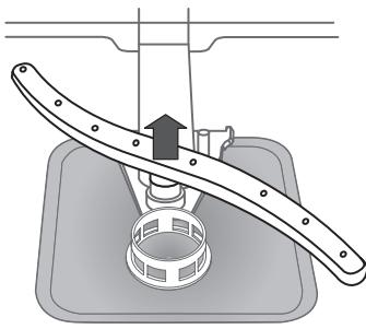
Нижнюю лопасть можно снять, потянув ее вверх.
