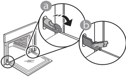
2. Die Tür so weit wie möglich schließen. Die Tür mit beiden Händen festhalten – diese nicht am Griff festhalten. Die Tür einfach entfernen, indem sie weiter geschlossen und gleichzeitig nach oben gezogen wird, bis sie sich aus ihrem Sitz löst. Die Tür seitlich abstellen und auf eine weiche Oberfläche legen.
