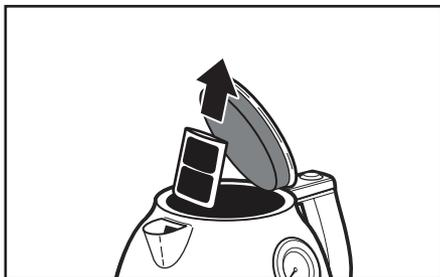
**Retrait du filtre** : Ouvrez le couvercle. Maintenez le haut du filtre, situé derrière le bec verseur, et tirez pour l'enlever.
