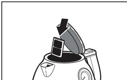
**Insertion du filtre** : Le filtre se trouve derrière le bec verseur à l'intérieur de la bouilloire. Ouvrez le couvercle. Glissez le filtre dans l'encoche située derrière le bec verseur, en vous assurant que la courbure extérieure du filtre corresponde à celle de la bouilloire.
