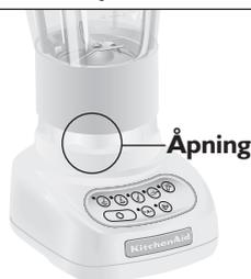
Beholderen er ikke ordentlig festet i låsekragen, slik at køggene ikke kobles. Ta beholderen av motordelen og sett den helt inn i kragen. Trykk beholderen ned og dreii den med urviseren i låsekragen forbi det andre klikket. Dette vil få beholderen til å koble til drevet. Se "Blendermontering".
