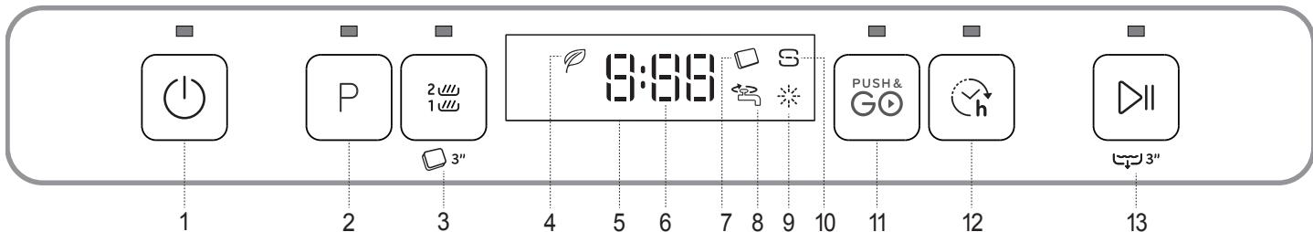
1. Ieslēgšanas-izslēgšanas/atiestatīšanas poga ar indikatora gaismiņu
