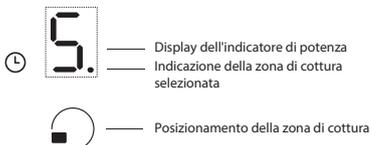
Una volta acceso il piano cottura e posizionata la pentola sulla zona prescelta, quindi attivare la zona premendo il corrispondente tasto di posizione. Sul display viene visualizzato il livello "5".
