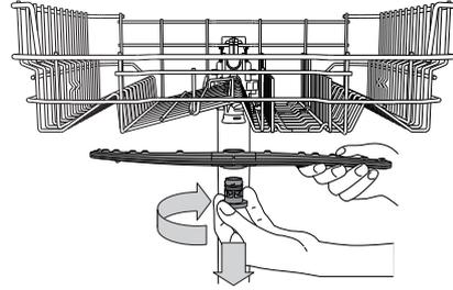
Pour enlever le bras d'aspersion supérieur, tournez l'anneau de verrouillage en plastique dans le sens antihoraire. Le bras d'aspersion supérieur doit être remplacé de façon que le côté avec le plus grand nombre de trous est placé vers le haut.
