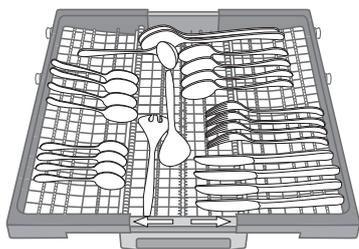
Il terzo cestello è stato progettato per alloggiare le posate durante il lavaggio. Disporre le posate come illustrato nella figura.
