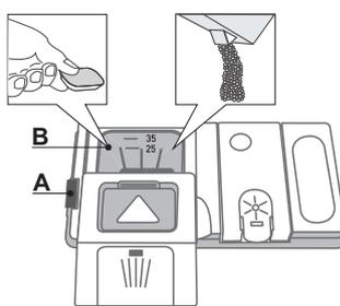
**Per aprire il distributore detersivo utilizzare il dispositivo di apertura A. Versare il detersivo esclusivamente nel distributore B asciutto. Mettere la dose di detersivo per il prelavaggio direttamente all'interno del distributore.**
