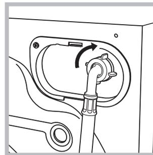
2. Das andere Ende des Schlauches an den oben rechts am Rückteil des Wäschetrockners befindlichen Wasseranschluss anschließen (siehe Abbildung).
