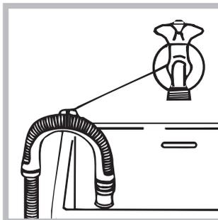
oder hängen Sie diesen in ein Becken oder eine Wanne ein; befestigen Sie den Schlauch in diesem Falle mittels der mitgelieferten Führung an dem Wasserhahn (siehe *Abbildung*). Das freie Ablaufschlauchende
