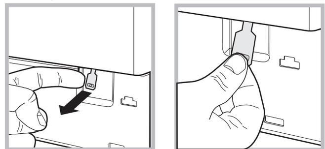
4. Befreien Sie mithilfe der auf der *Abbildung* veranschaulichten Zunge (nach vorne ziehen) die Kunststoff-Spannvorrichtung aus der Arretierung; ziehen Sie letztere dann nach unten und öffnen Sie gleichzeitig die Gerätetür.
