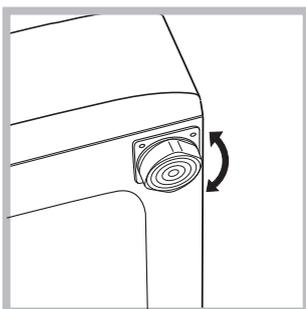
2. Sollte der Boden nicht perfekt eben sein, müssen die Unebenheiten durch An- bzw. Ausdrehen der vorderen Stellfüße ausgeglichen werden (siehe Abbildung), der auf der Arbeitsfläche zu ermittelnde Neigungsgrad darf 2°
