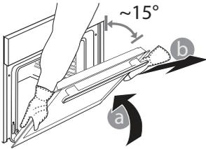
**3. Per rimontare la porta, avvicinarla al forno allineando i ganci delle cerniere alle proprie sedi e ancorare la parte superiore agli alloggiamenti.**
