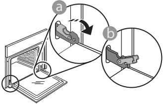
**2. Chiudere la porta fino a quando è possibile. Prendere saldamente la porta con entrambe le mani, evitando di tenerla per la maniglia.**
