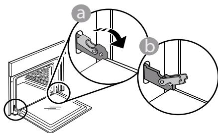
Dvířka snadno vysadíte tak, že je budete nepřetržitě zavírat a současně za ně táhnout, dokud se neuvolní z usazení. Odložte dvířka na stranu na měkký povrch.
