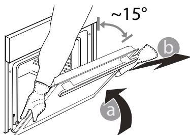
**3.** Įstatydamis dureles pastumkite jas link orkaitės, suligiuokite vyrių kabliukus tvirtinimo vietose ir užfiksodami viršutinę dalį.
