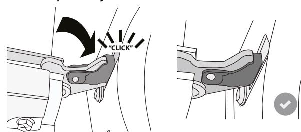
5. Pokušajte da zatvorite vrata i proverite da li su u istoj ravni sa kontrolnom tablom. Ukoliko nisu, ponovite gore opisane korake: Vrata se mogu oštetiti ukoliko nisu nameštena kako treba.
