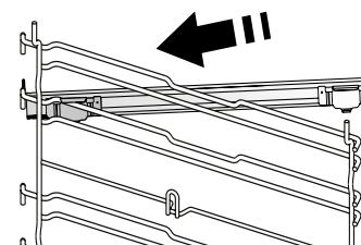
Viršutinj grotelių fiksatorių pritvirtinkite prie skersinių grotelių ir nustumkite jį iki galio. Į tą padėtį nuleiskite ir kitą fiksatorij.
