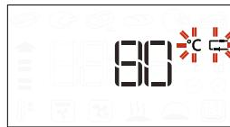
Nospiediet vai lai apstiprinātu un sāktu gatavošanas ciklu. Gatavošanas cikla laikā, displejā būs redzama gaļas zondes mērķa temperatūra. Kad gaļa sasniegs iestatīto temperatūru, gatavošanas cikls beigsies un siplejā būs redzams uzraksts „End”.
