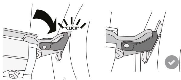
**5.** Zkuste dvířka zavřít a zkontrolujte, zda jsou v jedné rovině s ovládacím panelem. Pokud tomu tak není, výše uvedený postup opakujte. Pokud dvířka správně nefungují, mohou se poškodit.
