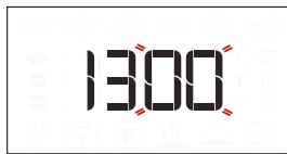
A kijelzőn villogni kezd a percet jelző két számjegy. A perc beállításához forgassa el a beállítógombot, majd hagyja jóvá az gombbal.
