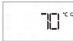
Stiskem spusťte nastavení. Otáčením ovladače nastavte cílovou teplotu sondy. Stiskem volbu potvrďte.
