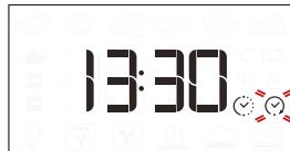
Szükség esetén forgassa el a beállítógombot a sütési idő kívánt végének beállításához, majd nyomja meg az gombot a jóváhagyáshoz és a funkció indításához.
