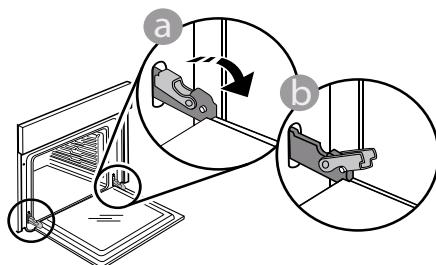
ih zatvarate dok ih istovremeno povlačite nagore i oslobađate iz njihovog ležišta. Položite vrata da leže na jednoj strani, na mekanoj površini.
