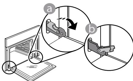
Išimkite dureles atlikti durių uždarymo veiksma ir šiek tiek patraukdami jų viršų, kad išlaisvintumėte iš tvirtinimo vietas. Išimtas dureles paguldykite ant minkšto paviršiaus.
