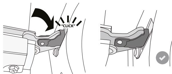
**5.** Poskusite zapreti vrata in preverite, da so poravnana z upravljalno ploščo. Če vrata niso poravnana, ponovite zgoraj opisane korake: Če se vrata ne odpirajo in zapirajo pravilno, se lahko poškodujejo.
