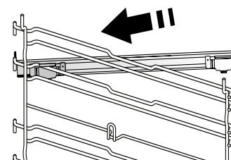
Připevněte horní sponu drážky k vodicí mřížce a suňte ji po celé délce až na doraz. Druhou sponu posuňte směrem dolů, dokud nedosáhne správné polohy.
