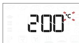
Jeżeli na ekranie miga ikonka °C/F, zmienić wartość za pomocą pokrętła, a następnie wcisnąć , aby zatwierdzić wybór i kontynuować zmianę ustawień kolejnych parametrów (o ile to możliwe).
