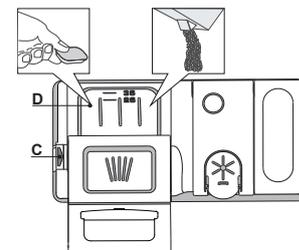
1. Hinsichtlich der Dosierung verweisen wir auf die zuvor erwähnte Information, in der die richtige Menge angegeben ist. Im Fach **D** sind Anzeigen die bei der Spülmitteldosierung helfen.
