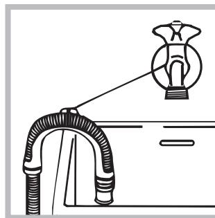
Або ж встановіть вихід зливного шланга на край рукоюйника або ванни, поєднавши напрямну (придбати яку можна у сервісному центрі) до крану (див. малюнок). Не залишайте вільний кінець зливного шланга зануреним у воду.
