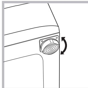
2. Yerleştirilecek zemin tam düz değilse çamaşır makinesinin vidalı ön ayaklarını s i k a r a k v e y a gevşeterek dengeyi sağlayınız (bkz. şekil); eğim açısı, makinenin üst tezgahına göre 2° den fazla olmamalıdır.
