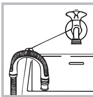
Alternatif olarak, kılavuzu musluğa (şekile bakın) bağlayarak tahliye oturumunu lavabo veya küvetin kenarına yerleştirin (teknik destek merkezinden satın alınabilir). Tahliye hortumunun serbest
