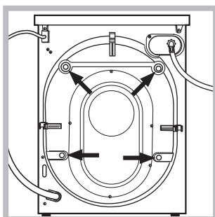
3. Αφαιρέστε τις 4 βίδες προστασίας για τη μεταφορά και το λαστιχάκι με το σχετικό διαχωριστικό, που βρίσκονται στο πίσω μέρος (βλέπε εικόνα).
