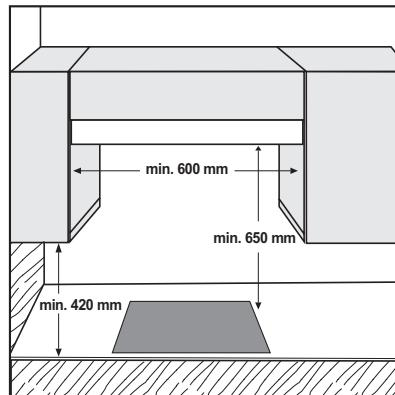
**ПРИМІТКА.** Якщо відстань «А» між настінними шафами має значення в діапазоні від 600 до 730 мм, висота «Б» повинна мати значення принаймні 530 мм. Якщо відстань «А» між настінними шафами більша за ширину варильної поверхні, висота «Б» повинна мати значення принаймні 400 мм. У разі встановлення витяжки над варильною панеллю див. інструкції виробника витяжки, щоб визначити правильну відстань.
