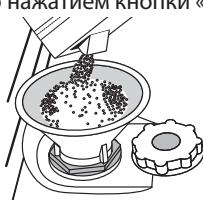
Вставьте воронку (см. рисунок) и заполните бачок солью до краев (примерно 1 кг). Ничего страшного, если вода перельется через край. Выньте воронку и протрите участок вокруг отверстия от остатков соли.
