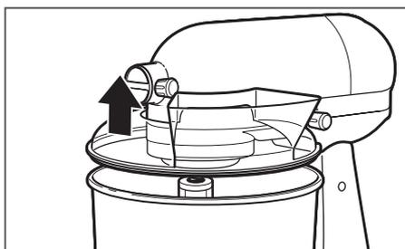
(VALGFRITT) Fjern skjold til miksebolle\*: Løft fremre kanten av skjoldet til miksebolle\* av kanten på bollen, og dra vekk fra kjøkkenmaskinen.
