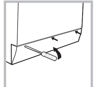
3. снимите переднюю панель стиральной машины при помощи отвертки (*см. схему*).
