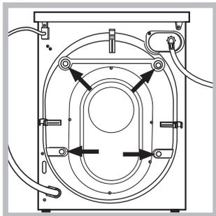
3. Scoateți cele 4 șuruburi de protecție pentru transport și cauciucul cu distanțierul respectiv, situate în partea posterioară (a se vedea figura).
