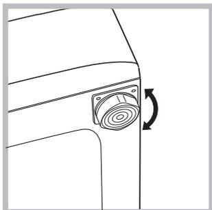
2. Dacă podeaua nu este perfect orizontală, compensați neregularitățile deșurubând sau înșurubând picioarele anterioare (a se vedea figura); unghiul de înclinare, măsurat pe planul de
