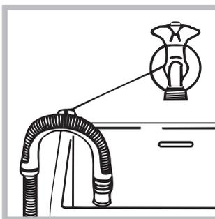
of hang hem aan de rand van een wasbak of badkuip, en bind de bijgeleverde steun aan de kraan (zie afbeelding). Het uiteinde van de afvoerslang mag niet onder water hangen.
