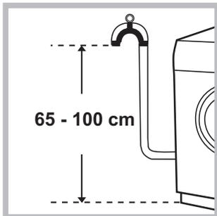
Conectați furtunul de evacuare, fără al îndoi, la o conductă sau la o gură de evacuare în zid, situate între 65 și 100 cm de pământ;
