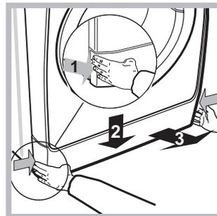
1. zdjąć panel z przedniej części urządzenia, naciskając go ku środkowi, a następnie popchnąć w dół z dwóch stron i wyjąć go (patrz rysunki).
