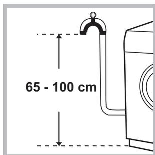
Podłączyć przewód odpływowy, nie zginając go, do rury ściekowej lub do otworu odpływowego w ścianie, które powinny się znajdować na wysokości od 65 do 100 cm od podłogi;
