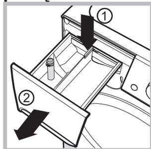
W celu wyjęcia szufladki nacisnąć dźwignię (1) i pociągnąć ją na zewnątrz (2) (patrz rysunek). Wypłukać szufladkę pod bieżącą wodą; czynność tę należy wykonywać często.
