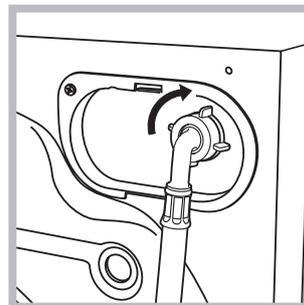
2. Podłączyć do urządzenia przewód doprowadzający wodę, przykręcając go do odpowiedniego przyłącza wody, znajdującego się w tylnej części pralki, z prawej strony u góry (patrz rysunek).
