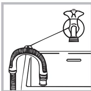
Oder hängen Sie den Ablaufschlauch in ein Becken oder eine Wanne ein; befestigen Sie ihn in diesem Falle mittels der Führung (beim Kundendienst erhältlich) an
