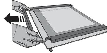
**2.** Sollevare e prendere saldamente il vetro interno con due mani, rimuoverlo e appoggiarlo su un piano morbido prima di eseguire la pulizia.
