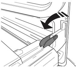
**2.** Zatvorite vrata koliko god je moguće. Čvrsto držite vrata sa obe ruke - ne držite ih za dršku. Jednostavno skinite vrata tako što ćete nastaviti da ih zatvarate dok ih istovremeno povlačite nagore (a) i oslobađate iz njihovog ležišta (b).
