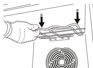
**2.** Чтобы вернуть нагревательный элемент в рабочее положение, поднимите и немного вытяните его на себя, а затем вставьте планку крепления в соответствующее гнездо.
