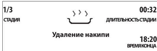
После завершения ополосните емкость парогенератора питьевой водой и запустите режим "Очистка паром", вынув из духовки все принадлежности. Это позволит предотвратить образование налета.
