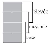
La zone flexible est divisée en trois zones de cuisson (voir la figure) activées à une puissance préétablie (élevée, moyenne ou basse) en fonction de la position de la casserole/poêle : déplacer la casserole/poêle sur la surface pour poursuivre la cuisson à des températures différentes sans de voir utiliser les commandes.
