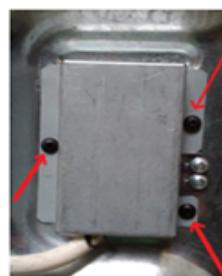
A tápkábel beszerelése után három csavarral csavarozza össze a fémfedeleket.
