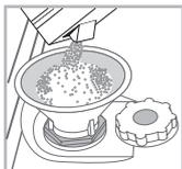
1. Wyjąć kosz dolny i odkręcić korek pojemnika, obracając go w kierunku przeciwnym do ruchu wskazówek zegara.
