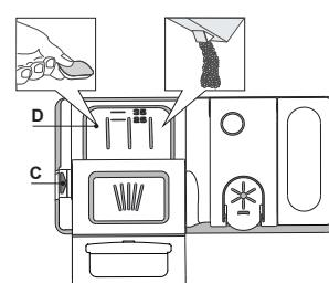
1. Для определения требуемого количества моющего средства см. указания выше. С внутренней стороны лотка **D** нанесены мерные отметки, позволяющие правильно дозировать моющее средство.
