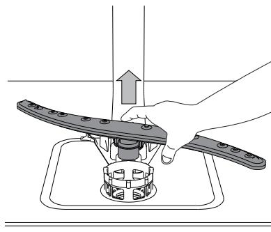
Нижнюю лопасть можно снять, потянув ее вверх.
