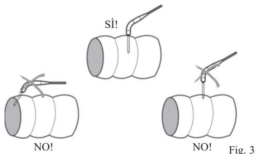
**Importante!** La sonda di temperatura al cuore deve essere inserita a fondo fino al centro del prodotto, assicurandosi che non esca (fig. 3) e deve essere maneggiata con attenzione perché è appuntita. Alla fine dell'abbattimento/ciclo di congelamento rapido, pulirla con un panno morbido e acqua tiepida e riporla nel supporto.
