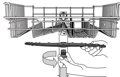
Za uklanjanje gornjeg nosača mlaznice okrenite plastični prsten za zadržavanje u smjeru suprotnom od smjera kazaljke na satu. Gornji nosač mlaznice treba se zamijeniti tako da je strana s većim brojem otvora okrenuta prema gore.
