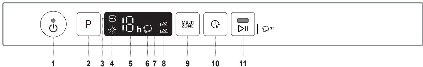
1. Dugme za uključivanje-isključivanje/ponovno podešavanje sa svetlosnim indikatorom
