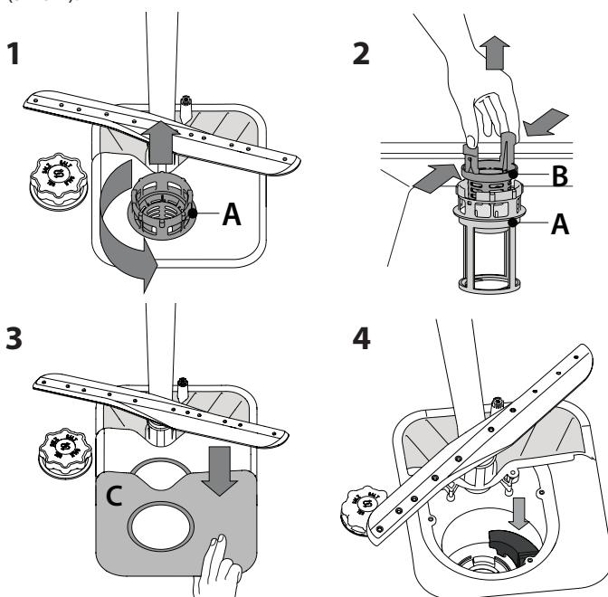
Nakon čišćenja filtera, ponovo postavite sklop filtera i pravilno ih pričvrstite na mesto; ovo je neophodno za efikasan rad mašine za pranje sudova.
