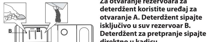
Za otvaranje rezervoara za deterdžent koristite uređaj za otvaranje A. Deterdžent sipajte isključivo u suv rezervoar B. Deterdžent za prepranje sipajte direktno u kadicu.
