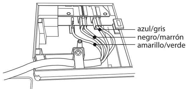
1. Retire la tapa del bloque de conexiones (A) desenroscando el tornillo e introduciendo la tapa en la bisagra (B) del bloque.
