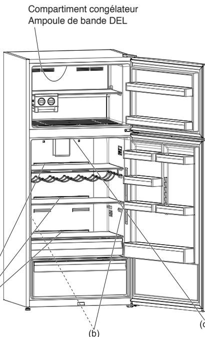
**Remarque** : Les chiffres et l'emplacement des bandes à DEL peuvent être modifiés selon le modèle.
