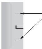
**Osadel mudelitel:** kui te panete külmutussektiooni toitu, ärge täitke seda üle täitejoonte, vastasel korral ei pruugi uks korralikult sulguda. Kui külmutussektiooni uks ei sulgu korralikult, võib külmutussektioonis hakata kogunema jää. Probleemi kordumise ennetamiseks kõrvaldage jää ja veenduge, et uks sulguks korralikult. Külmutus- ja/või külmikusektiooni avatuks jätmine suurendab ka energiakulu.
