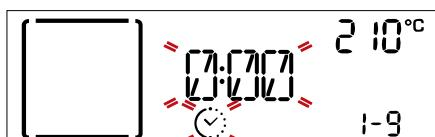
Când pictograma clipește pe afișaj, utilizați **butonul de reglare** pentru a seta durata de preparare dorită și apoi apăsați pe **OK select** pentru a confirma.
