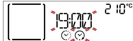
Forgassa el a beállítógombot a sütési idő kívánt végének beállításához, majd nyomja meg a <sup>OK</sup> <sub>select</sub> gombot a jóváhagyáshoz és a funkció indításához. Helyezze az ételt a sütőbe, és csukja be az ajtót: A funkció automatikusan bekapcsol, amikor letölök a sütés elkészültéhez megadott időpont alapján kiszámított időtartam.
