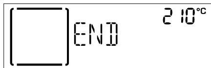
Натисніть **OK select**, щоб продовжити приготування у ручному режимі (без урахування запрограмованого часу приготування) або повертайте **ручку регулювання** для збільшення часу готовування, налаштувавши інше значення тривалості. В обох випадках налаштування температури чи рівня грилю буде збережено.
