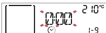
Ked' na displeji bliká ikonka , pomocou nastavovacieho ovládača nastavte požadovaný čas prípravy jedla a potvrdíte stlačením **select** .
