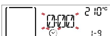
Коли на дисплей блимає значок **⌚**, за допомогою кнопки регулювання встановіть бажаний час готовування, а потім натисніть кнопку **OK select** для підтвердження.
