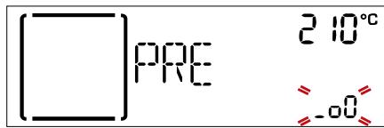
Після завершення фази пролунає звуковий сигнал, а на дисплеї з'явиться сповіщення про те, що духовна шафа досягла заданої температури:
