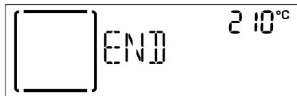
Нажмите *OK select*, чтобы продолжить приготовление в ручном режиме (без задания длительности приготовления), или увеличьте длительность при помощи *ручки регулировки*.
