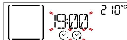
Pagrieziet *pielāgošanas slēdzi*, lai iestatītu vēlamo gatavošanas beigu laiku, un nospiediet  $\frac{\text{OK}}{\text{select}}$ , lai to apstiprinātu un aktivizētu funkciju. Ielieci pārtiku cepeškrāsnī un aizveriet durvis: Tiklīdz būs pagājis laiks, kas aprēķināts, lai gatavošana beigtos jūsu noteiktajā laikā, funkcija sāks automātiski darboties.
