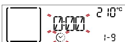
Ja displejā mirgo ikona  $\odot$ , izmantojiet *pielāgošanas slēdzi*, lai iestatītu vēlamo gatavošanas laiku, un nospiediet  $\frac{\text{OK}}{\text{select}}$ , lai apstiprinātu.
