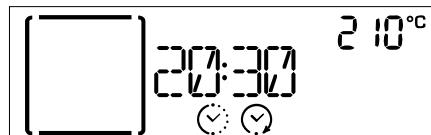
Примітки: У разі програмування часу відкладеного запуску готовування фазу попереднього прогрівання буде скасовано: Розігрівання духової шафи до встановленої температури буде поступовим, а це означає, що час готовування буде трохи більшим за час, наведений у таблиці приготовування.
