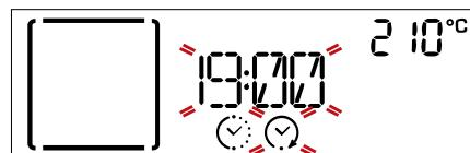
Otáčaním nastavovacieho ovládača nastavte želaný čas ukončenia pečenia, potvrdíte stlačením **OK select** a spustite funkciu.
