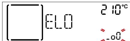
A szakasz végeztével hangjelzés hallható, és a kijelzőn üzenet jelzi, hogy a sütő elérte a megadott hőmérsékletet:
