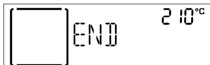
Stlačením **OK select** pečenie pokračuje v manuálnom režime (bez naprogramovaného času pečenia) alebo otočením **nastavovacieho ovládača** predĺžite čas pečenia nastavením nového trvania.
