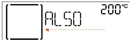
Menüpont kiválasztásához (a kijelzőn az első elérhető elem látható) forgassa a beállítógombot addig, amíg a kívánt elem nem látható.
