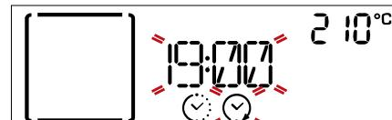
Вращая ручку регулировки, установите желаемое время окончания приготовления и нажмите OK select, чтобы подтвердить значение и ввести в действие выбранный режим.
