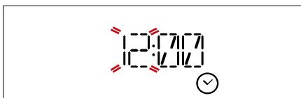
Вращая ручку регулировки, установите значение часа и нажмите OK: На дисплее начнут мигать две цифры минут.
