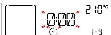
Όταν αναβοσβήνει το εικονίδιο **⌚** στην οθόνη, χρησιμοποιήστε τον επιλογέα ρύθμισης για να ρυθμίσετε το χρόνο που απαιτείται για να ολοκληρωθεί το μαγείρεμα, στη συνέχεια πατήστε το **OK select** για επιβεβαίωση.
