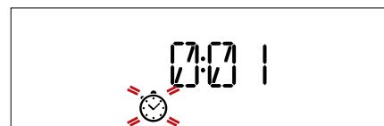
Roțiți **butonul de reglare** pentru a seta durata de timp necesară și apoi apăsați **OK select** din nou pentru a activa temporizatorul.
