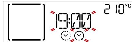
Otačejte nastavovacím knoflíkem a nastavte požadovaný čas ukončení přípravy. Poté pro potvrzení volby a spuštění funkce stiskněte OK select. Vložte pokrm do trouby a zavřete dvírka: Funkce se spustí automaticky po určité době, která byla vypočtena tak, aby příprava pokrmu byla dokončena ve vám nastaveném čase.
