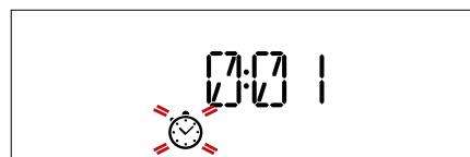
Otáčením **nastavovacího knoflíku** nastavte požadovanou dobu přípravy a poté, pro zapnutí časovače, opětovně stiskněte **OK select**. Po ukončení odpočítávání času nastaveného na časovém spínači zazní signál a na displeji se zobrazí upozornění.
