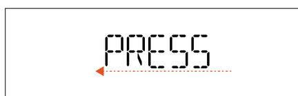
Ekranda ilgili mesaj gösterildiğinde, gerekirse beş dakikalık bir üstünü kızartma çevrimini başlatmak için **OK select** 'e basın.
