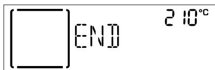
Пісіруді қол режимінде (бағдарламаланатын пісіру уақытының) жалғастыру үшін **OK** түймесін басыңыз немесе жаңа уақытты орнату арқылы пісіру ұзақтығын ұлғайту үшін *РЕМТЕУ ТЕМІГІН* пайдаланыңыз.
