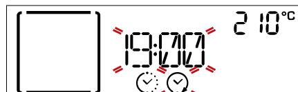
Pişirme işleminin sona ermesini istediğiniz saat ayarlamak için **ayar düğmesini** çevirin ve onaylamak ve işlevi başlatmak için **OK select** 'e basın.
