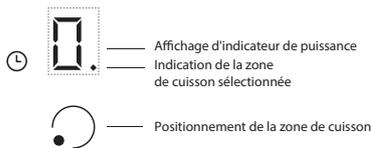
Positionner la casserole sur la zone de cuisson souhaitée. Allumer la plaque de cuisson. Puis activer la zone de cuisson sélectionnée en appuyant sur le bouton de position correspondant. L'afficheur indique « 0 ». Il est possible de sélectionner
