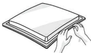
Coloque la placa en la abertura realizada en la encimera respetando las dimensiones indicadas en las instrucciones de instalación.
