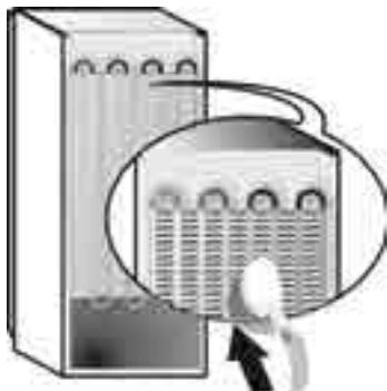
Kako bi se omogućio stalan i pravila protok vode odleđivanja, redovit čistite unutrašnjost ispusta na stražnjem dijelu hladnjaka u blizini ladice za voće i povrće pomoću isporučenog alata.
