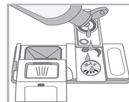
1. Abrir el depósito "D" pulsando y levantando la lengüeta de la tapa;
