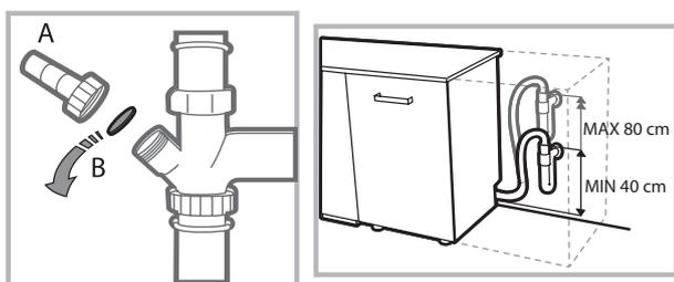
Antes de conectar el tubo de descarga del agua al sifón del lavabo, quitar el tapón de plástico (B).
