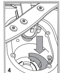
Después de la limpieza de los filtros, volver a montar el grupo filtrante y a colocarlo correctamente en su lugar. Esto es fundamental para el buen funcionamiento del lavavajillas.
