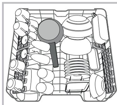
Algunos modelos de lavavajillas tienen sectores reclinables\*, utilizables en posición vertical para colocar platitos de té o de postre, o en posición horizontal para colocar escudillas y recipientes.
