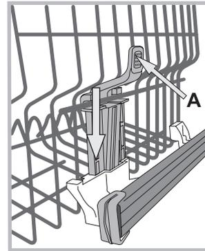
Si el cesto tiene **Lift-Up\*** (ver la figura), sujetarlo por los costados y levantarlo. Para volver a la posición inferior, pulsar las palancas (A) a los costados del cesto y acompañarlo hacia abajo.
