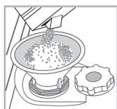
1. Extraer el cesto inferior y desenroscar el tapón del depósito en sentido antihorario.
