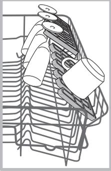
Las copas se pueden colocar de forma estable sobre las solapas, introduciendo el pie en las ranuras correspondientes. Para optimizar el secado, poner las solapas con la mayor inclinación. Para variar la inclinación, levantar la solapa, desplazarla suavemente y ponerla en la posición deseada.
