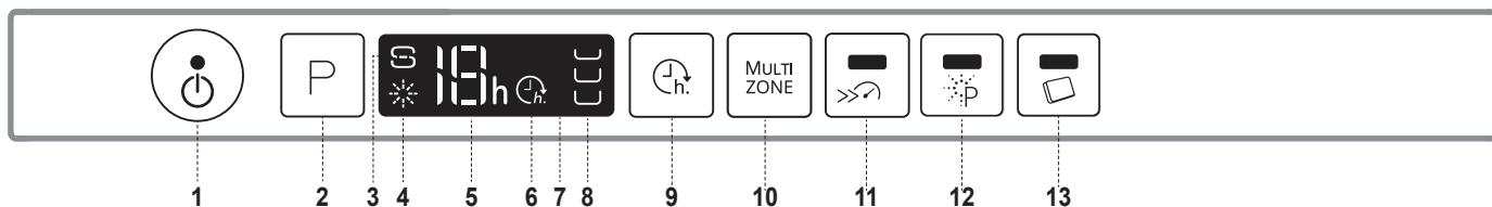
1. Dugme za uključivanje-isključivanje/ponovno podešavanje sa svetlosnim indikatorom
