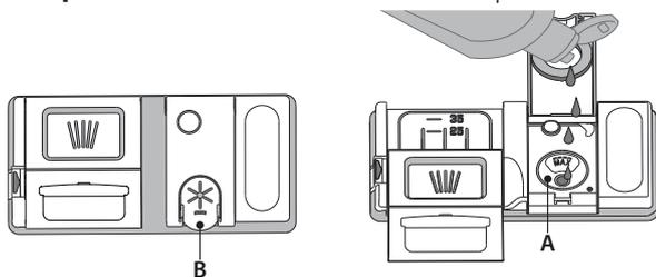
5. Откройте дозатор **B**, нажав и потянув вверх язычок крышки.
