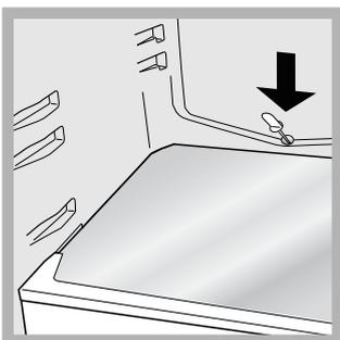
descarga (*ver la figura*) donde el calor producido por el compresor la hace evaporar. La única intervención que se debe realizar periódicamente consiste en limpiar el orificio de descarga para que el agua pueda fluir libremente.
