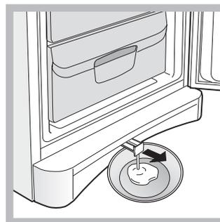
Certains de nos appareils sont équipés du SYSTEME DRAIN pour acheminer l'eau vers l'extérieur: laissez l'eau s'écouler dans un récipient (voir figure).
