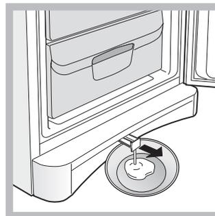
SYSTÉMEM sloužícím k odvádění vody směrem ven: nechte vodu odtékat do nachystané nádoby (viz obrázek).
