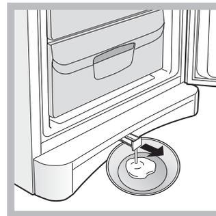
5. Alcuni apparecchi sono dotati del SISTEMA DRAIN per convogliare l'acqua all'esterno: lasciare che l'acqua defluisca in un contenitore (*vedi figura*).
