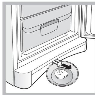
SYSTEM DRAIN do odprowadzenia wody na zewnątrz: aby woda ściekała do pojemnika. (patrz rysunek).
