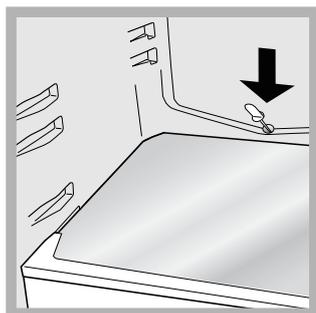
za pomocą odpowiedniego otworu (patrz rysunek), gdzie ciepło wytworzone przez sprężarkę powoduje jej odparowanie. Jedyną czynnością jaką należy wykonać co jakiś czas, to wyczyszczenie otworu odpływowego tak, aby woda mogła swobodnie wyciekać.
