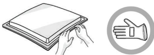
Posicione a placa sobre a abertura da bancada que foi feita respeitando as dimensões indicadas nas Instruções.
