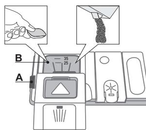
**Pour ouvrir le distributeur de détergent, utilisez le dispositif d'ouverture A. Insérez le détergent dans le distributeur sec B seulement. Placez la quantité de détergent pour le pré-lavage directement dans la cuve.**
