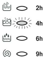
Efter en stund kommer kontrollampan att börja blinka för att visa hur lång tid som återstår:
