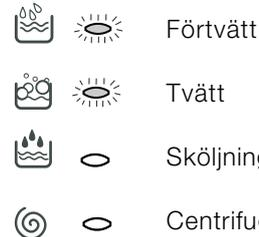
Obs: under tömningsfasen tänds kontrollampan för centrifugeringsfasen.
