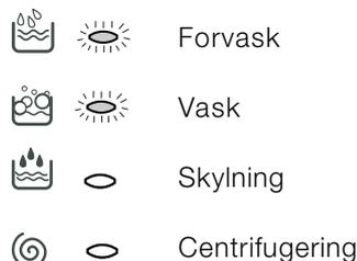
Bemærk: i tømningsfasen tændes kontrollampen for Centrifugering.
