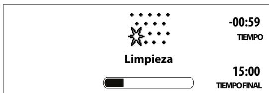
Cuando termine el ciclo, un mensaje parpadeará en la pantalla. Se indicará la temperatura residual en la pantalla y la puerta permanecerá bloqueada hasta que la temperatura del interior del horno vuelva a un nivel seguro.
