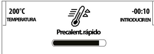
Cuando el precalentamiento haya terminado sonará una señal acústica para indicar que el horno ha alcanzado la temperatura ajustada. Coloque los alimentos en el horno e inicie la cocción pulsando  $\triangleright$ : el horno utilizará automáticamente la función Convencional.
