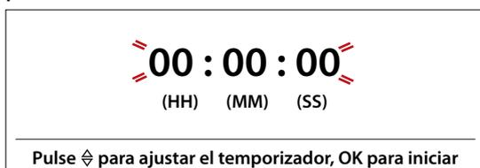
Pulse  $\wedge$  o  $\vee$  para seleccionar el tiempo que necesita y pulse  $\frac{OK}{select}$  para activar el temporizador. Una vez que haya finalizado la cuenta atrás sonará una señal acústica.
