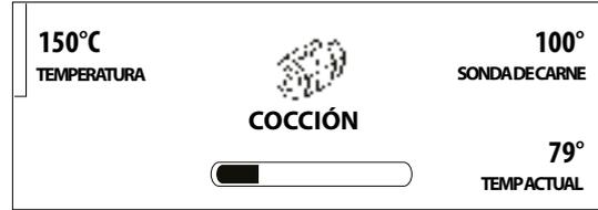
Sonará una señal acústica y la pantalla indicará que la sonda de alimentos ha alcanzado la temperatura necesaria.
