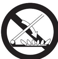
**ATENȚIE!** Capacul din sticlă se poate sparge dacă este încălzit. Stingeți toate arzătoarele sau eventualele plite electrice înainte de a-l închide.\*Se referă numai la modelele cu capac de sticlă
